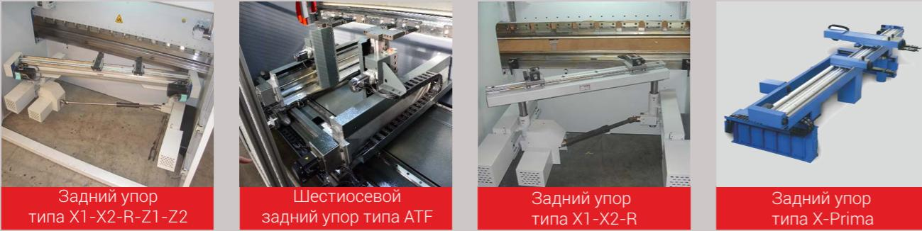
Конструкция заднего упора – это один из узлов листогибочного пресса, выбору которого уделяется особое внимание. В зависимости от того, требуется ли многоэтапная гибка сложной или простой геометрии детали, у листогибочного сервопресса Dener Makina есть возможность выбрать различные варианты исполнения заднего упора. Все модели задних упоров достигают высокой точности позиционирования, сохраняя при этом высокие скорости перемещения.
