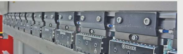
Пневматическое Крепление Инструмента
